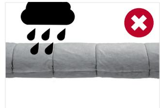
Abbildung 27: Isolierung nicht ungeschützt lassen.
