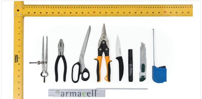
Abbildung 5: Empfohlene Werkzeuge für die Verarbeitung von ArmaGel HT.
