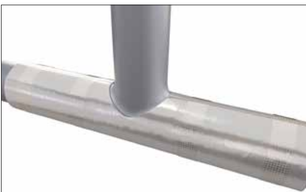
Abbildung 23: Dämmstoffschicht mit Filamentband fixieren
