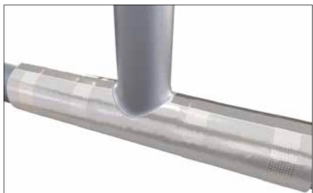
Abbildung 24: Symmetrisches T-Stück mit Dampfsperrenband fixieren
