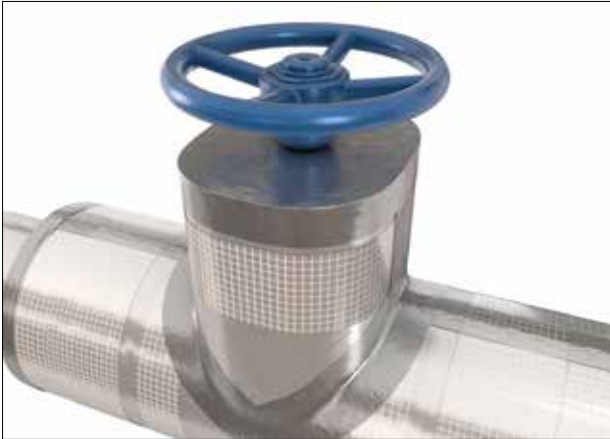
Abbildung 51: Dampfsperrenband an allen Längs- und Stoßnähten anbringen
