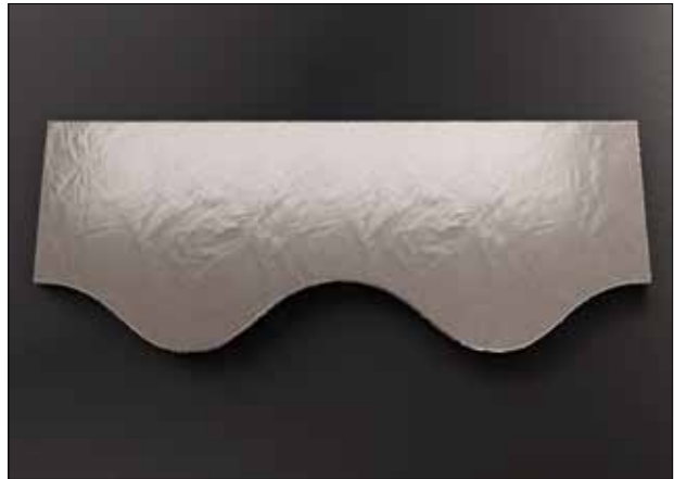
Abbildung 48: Formteil für Ventilanschluss anfertigen
