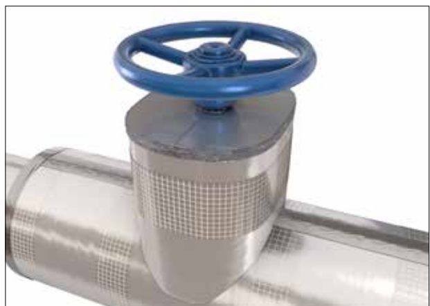
Abbildung 50: Oberseite der Ventilspindel dämmen
