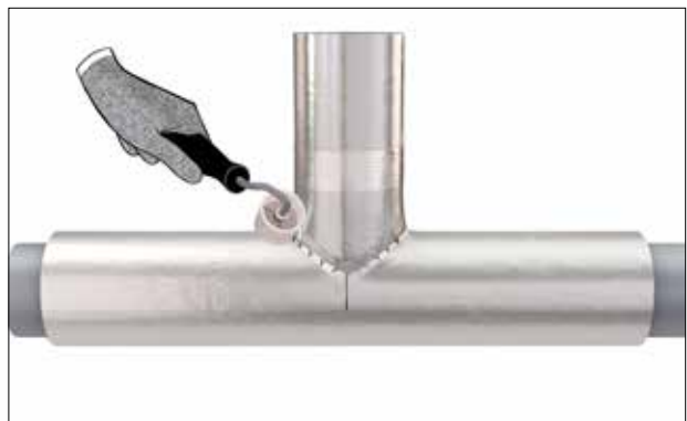
Abbildung 73: Nähte mit der Rolle fixieren
