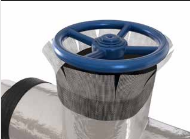
Abbildung 56: Flexible Verstärkungsmembran am Abschluss der Spindeldämmung anbringen
