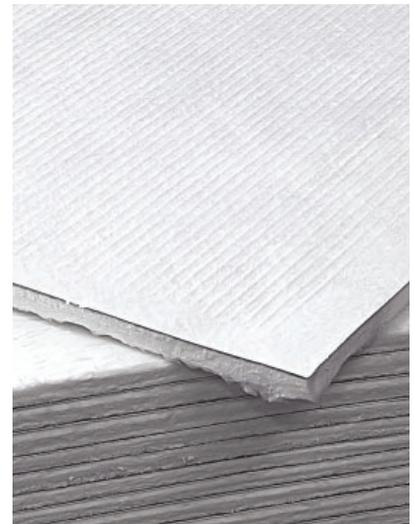
**Grundprodukt:** Spaceloft A2**Aufbau:** Zuschnitt und Verklebung mehrerer Lagen Aerogel-Vlies Spaceloft A2 roll 10mm mit einer 2mm Kaschierung aus gewebeverstärktem Polypropylen.
